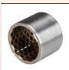
FB08G 固体润滑轴承是以 JF-800 双金属材料为基体，再埋入特殊固体润滑剂制作成的新型滑动轴承。由于高强度承载的合金材料作基体，并经过严格选择的高分子填充材料为耐磨剂，合理的螺旋角度菱形块状均布的润滑面，润滑面积达 25%。因此，能发挥超强的低摩擦，良好的润滑性和抗磨耗性。该产品已广泛应用于起重起、发电机、升降机、吊车及冶金机械等行业。
