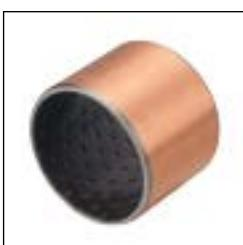
该产品是以优质低碳钢板为基体，中间烧结一层多孔青铜层，表面扎制聚甲醛(PTFE)和(Pb)的混合物。能提供较好的承载性和耐磨损性。产品应用于汽车底盘、锻压机床、冶金机械、矿山机械、水利机械、轧钢行业等。
