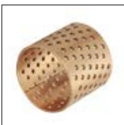
该产品是在FB-090材料的基础上改进而成，表面按一定角度和密度有序地排列润滑通孔，它具有延长使用期及润滑间隔频率，减少磨损等优点。
