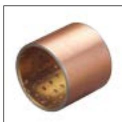
该产品以优质的低碳钢为基体，表面烧结锡青铜合金，经多次烧结扎制而成，它有很高的疲劳强度和承载能力，高的抗冲击力。产品适用于发动机连杆，变速箱齿轮，工程机械、农业机械等。
