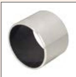
该产品以优质的低碳钢板为基体，中间烧结多孔青铜层，表面扎制聚四氟乙烯(PTFE)和(Pb)的混合物。它能提供较好的自润滑、耐磨损、低摩擦等性能，充分发挥了金属和多元素聚合物的优点。产品应用于印刷机械、纺织机械、烟草机械、健身器等。
