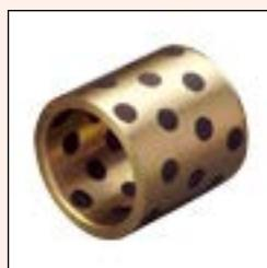
该产品以特殊配方的高力黄铜为基体，表面按一定角度和密度镶嵌特殊配方的固体润滑剂，经紧密加工而成。产品广泛应用于连铸机、矿山机械、船舶、气轮机等。
